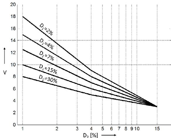
**Bild 4-2:** Ermittlung des Spektral-Überhöhungsfaktors
